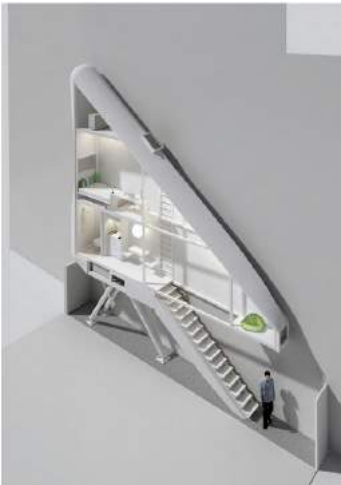
VARSOVIE, Pologne : Projet Keret House, CENTRALA Architects. 1,33 m de large sur 12 m de long, l'escalier est rétractable.
